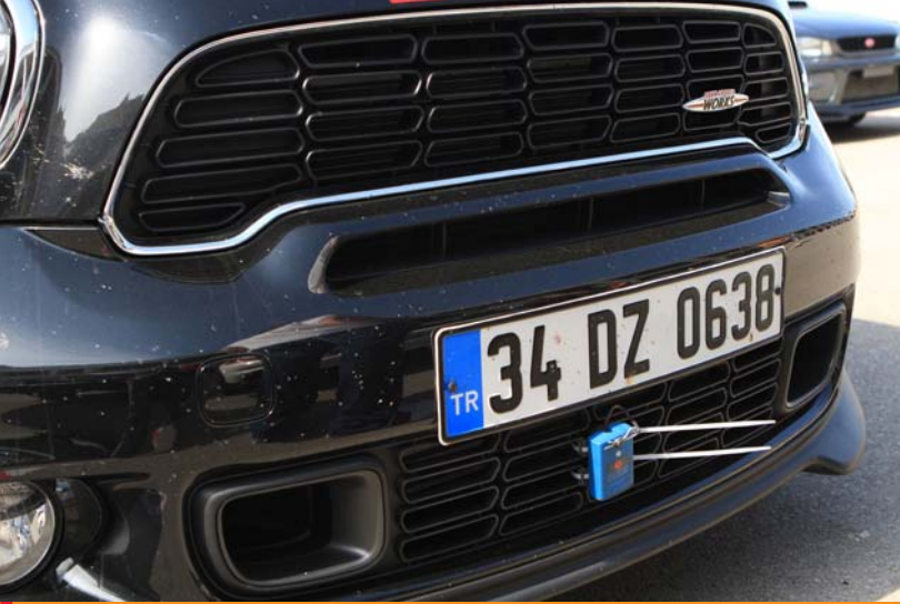
Radyatör ızgarasındaki mavi parça tur zamanı tutmaya yarayan tranponder. Kirası 120 TL.
