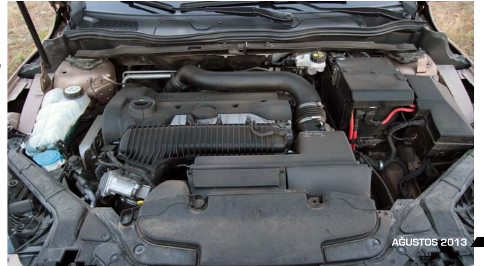
MINI'NİN 4 SİLİNDİRLİ 1.6 LT'LİK MOTORU 218 HP, VOLVO'NUN 5 SİLİNDİRLİ 2.0 LİTRELİK MOTORU İSE 213 HP GÜÇ ÜRETİYOR. TORKLAR 300 NM.
